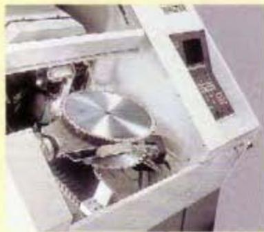
Cargador de producción de alto rendimiento con brazo magnético bilateral. Toma de la hoja de sierra afilada y entrega de la hoja de sierra por afilar en un solo paso de trabajo.
