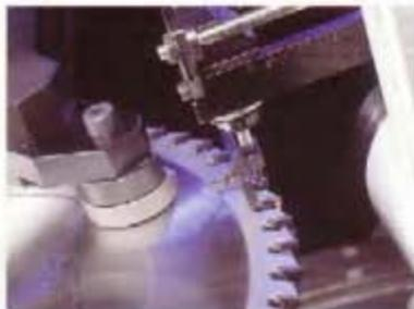
*El palpador de medición de serie controla el posicionamiento y mide, antes de empezar a afilar, todos los parámetros necesarios, por ejemplo, el grosor de hoja, ancho de corte, diámetro, etc.*
